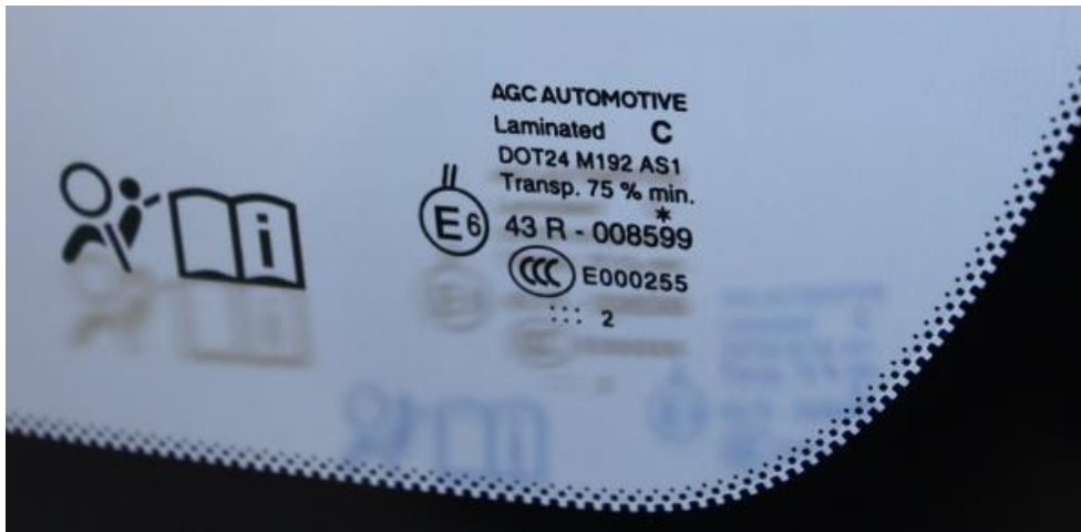
Fot.3a. Zdjęcie szyby czołowej – widok oznaczeń identyfikacyjnych szyby.
