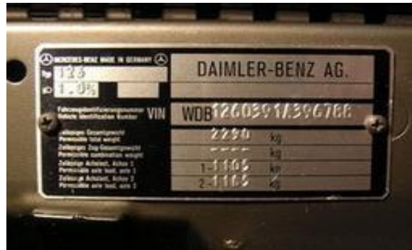
Fot.1a. Zdjęcie VIN na tablicy znamionowej.
