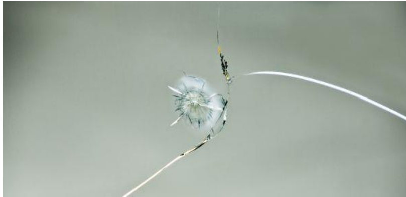
Fot.4. Uszkodzenie szyby bez oznaczenia markerem.
