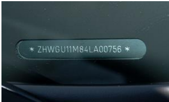
Fot.1. Zdjęcie VIN na podszybiu.
